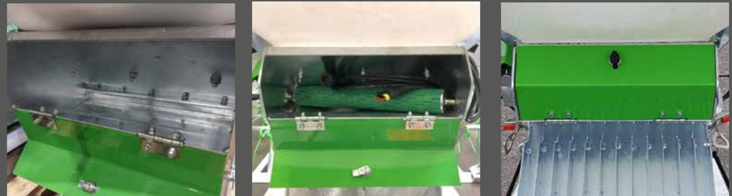
Geïntegreerde opslag voor een extra zaairotor, klemmen etc. Integrated storage for an extra seed rotor, clamps, etc. Integrierter platz für extra Säwelle, Materiale, usw. Bac intégré pour contrôle rapide et précis de débit Espacio de almacenamiento para cables o ejes de siembra
