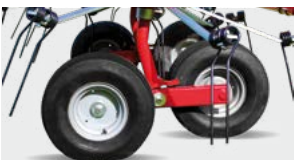
Tandem wheels on the trailed model (G6V 740 PTH) Roues tandem sur le modèle traîné (G6V 740 PTH).
