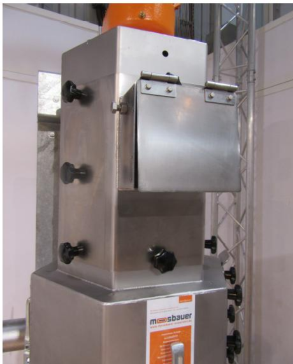
Kuva 5: Kiinteän aineen poistoluukku
