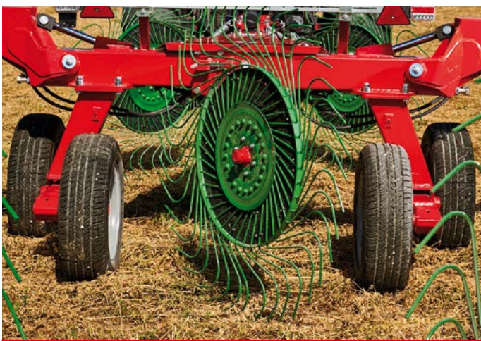
Assale tandem di serie su entrambi i modelli. Tandem axles standard on both models.
