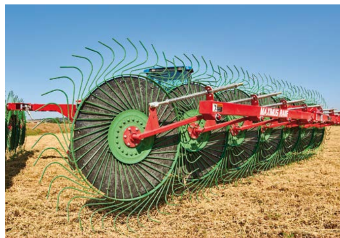
Bracci per ruote stellari indipendenti. Independent rake wheel arms.
