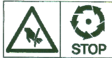
Attentie bij werkzaamheden aan de snijverdelers
